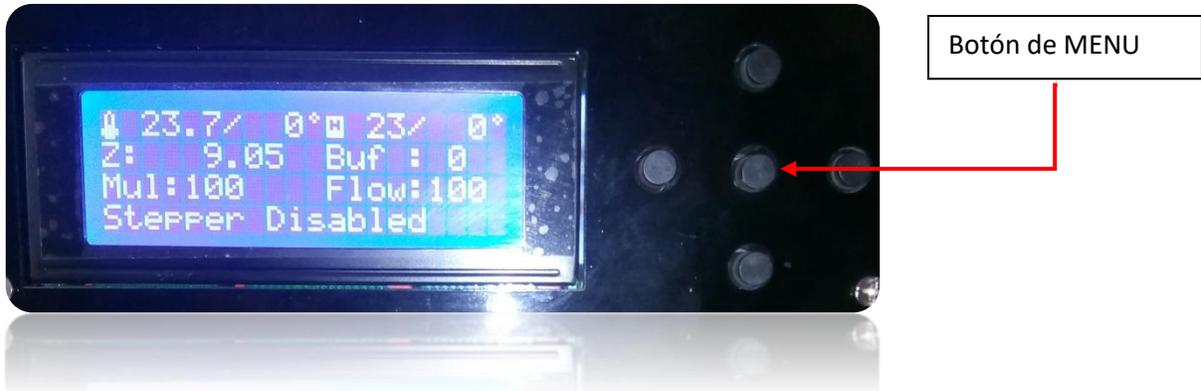
En este submenú nos desplazaremos a la opción Quick Settings (configuración rápida), utilizando el botón de desplazamiento hacia abajo de nuestro panel de control
