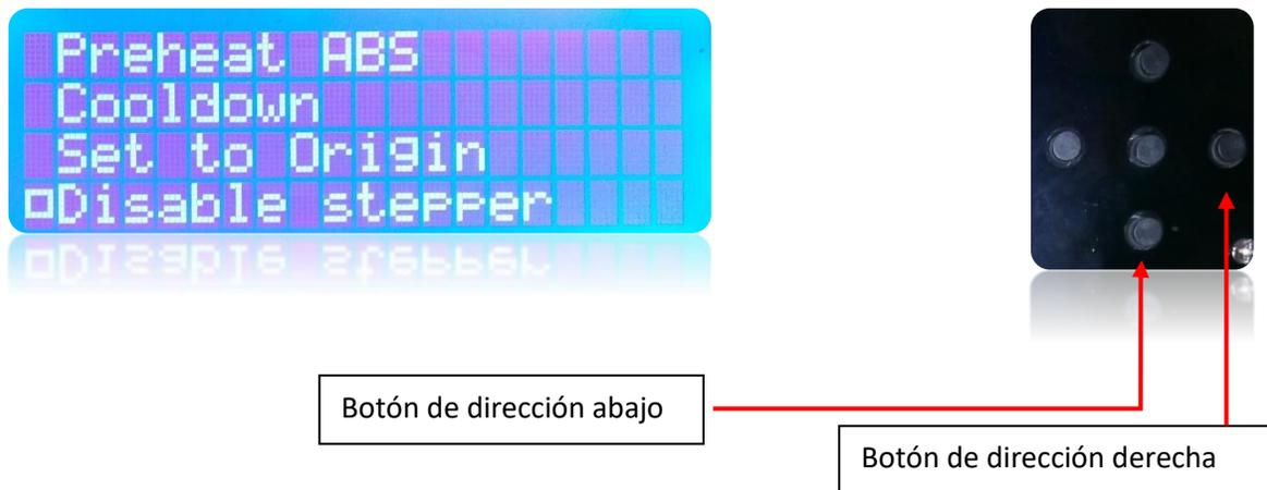
Una vez deshabilitado los motores de impresora, se puede mover el extrusor y la cama caliente de forma libre.
