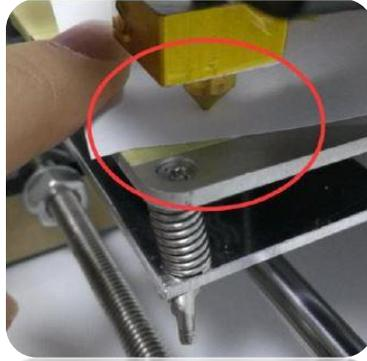
La hoja de papel debe desplazarse de tal manera que se sienta un ligero rozamiento entre esta y la boquilla. Si la boquilla, queda a una distancia muy alta con respecto a la cama caliente, la calidad de la impresión será de calidad muy baja. Si la boquilla queda a una distancia muy pegada a la cama caliente, el filamento tendrá dificultad en salir de la boquilla, y puede generarse un taponamiento u obstrucción de esta.
